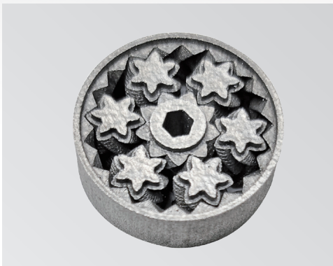
样品名称：轴承活动件 打印设备：FS121M 打印材料：FS 316L
